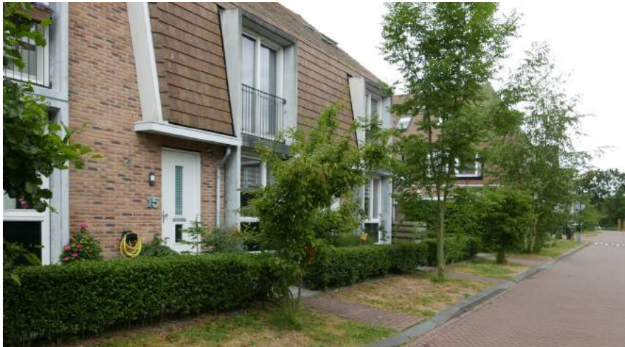
dakkapellen zijn integraal onderdeel van het gevelontwerp
